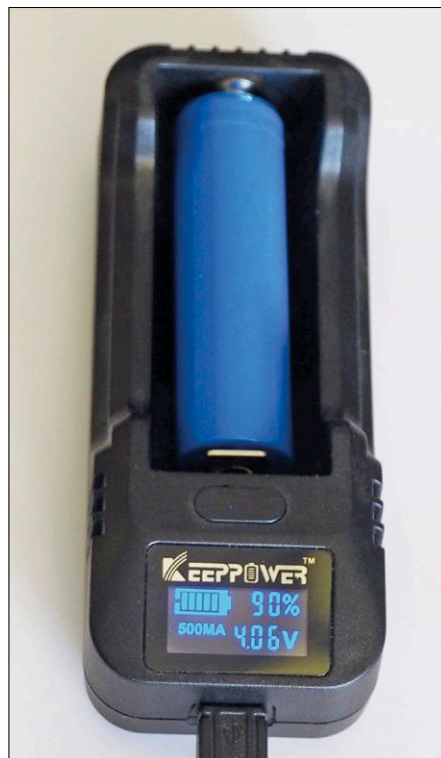
Figuur 10. Goedkope kleine lader voor LiCo 2 -cellen van het formaat 18650 met USB-aansluiting en display met organische LEDs.
